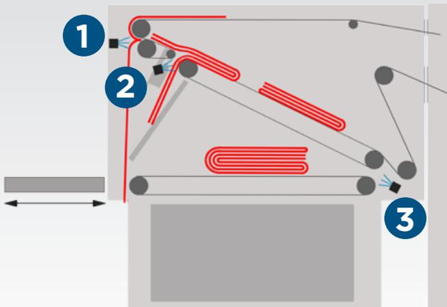
Dos pliegues longitudinales de serie y un tercer pliegue longitudinal (opcional) para piezas de gran tamaño.
