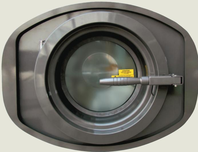
La puerta de carga, de aleación de aluminio, es de grandes dimensiones y está equipada con un cierre de seguridad controlado por el Computer **DIALOG** que impide la apertura antes de que el ciclo haya concluido y que todos los vapores residuales hayan sido extraídos de las prendas.
